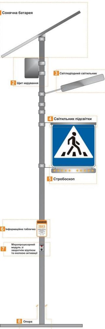
1 Сонячна батарея (установка незалежного живлення) може бути використана для живлення в місцях, де доступ до ліній електропостачання ускладнений або взагалі неможливий.
